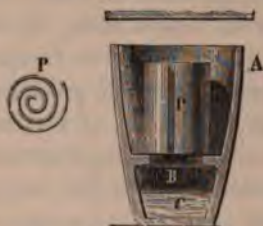
Fig. 249. — Pot à céruse avec spirale de plomb.
